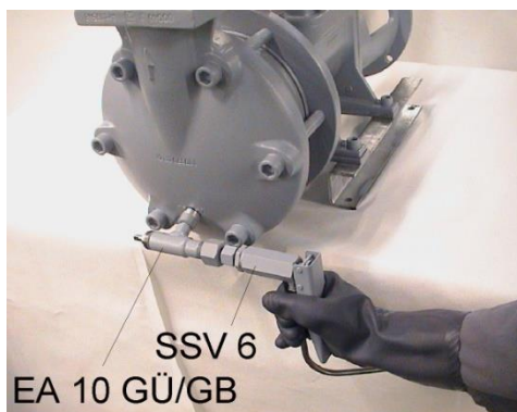
Рисунок 13-1 Слив масла через запорный и быстродействующий клапан
