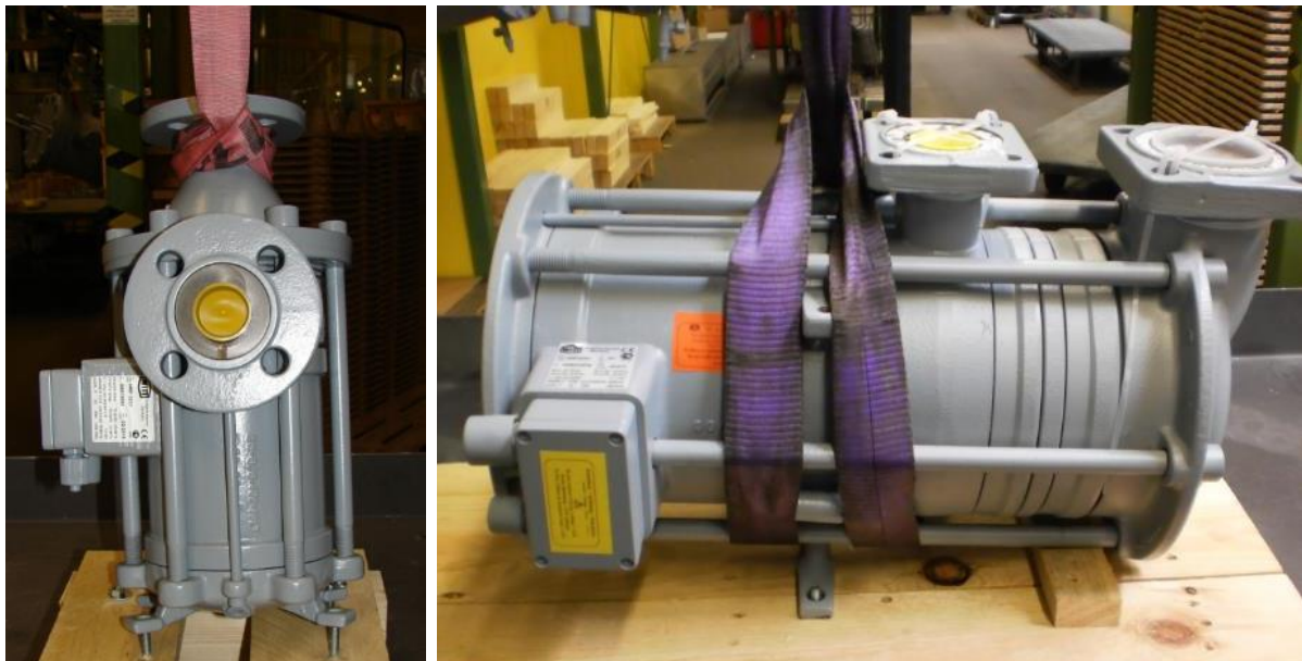
Рис. 7-1 Поднятие насоса HRP 3232 Рис. 7-2 Поднятие насосов HRP 5040, HRP 5050, HRP 8050, HRP 8050-2, HRP 10080
